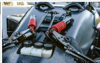
Das Arbeitsgerät von Lukas Eugster: Hinten am Sportprototypen staunt man über den gewaltigen Doppeldiffusor, vorne über die Mechanik der zwei liegenden Dämpfer.
