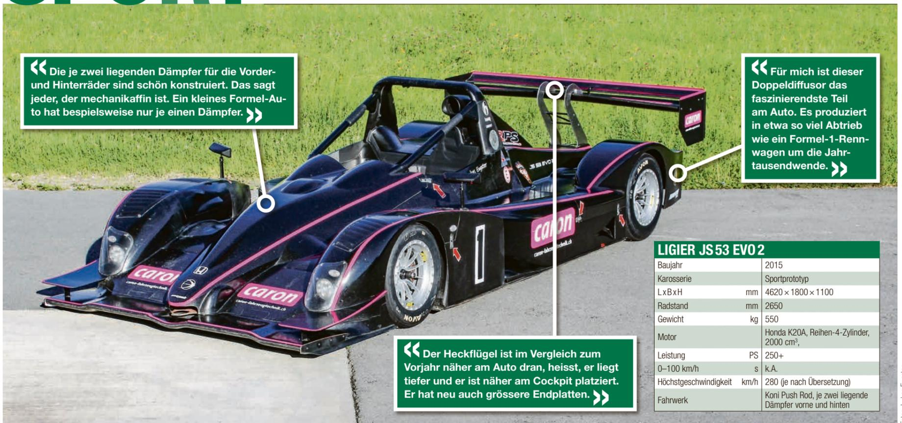
« Die je zwei liegenden Dämpfer für die Vorder- und Hinterräder sind schön konstruiert. Das sagt jeder, der mechanikaffin ist. Ein kleines Formel-Auto hat beispielsweise nur je einen Dämpfer. »
